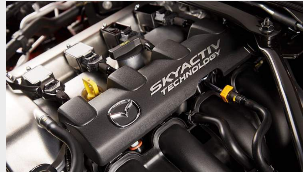
MOTOR: BENZINDIREKTEINSPRITZER MIT SEHR HOHER VERDICHTUNG
